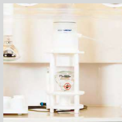
Система глубокой очистки кислот АОК-70
