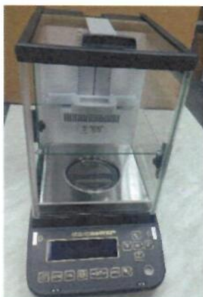
Общий вид модификации ВЛА-xxxМА (исполнение с автоматизированной витриной и регулируемым по высоте внутренним ветрозащитным экраном)
